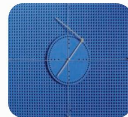
Kosekans: Die Messung des Kosekans beginnt im Mittelpunkt des Kreises und folgt der „y“-Achse bis zum Schnittpunkt mit der Geraden, die den Kreis berührt und senkrecht zum Radius steht.
